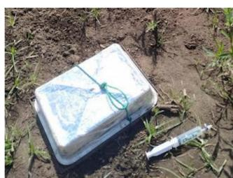
Figura 3: Cámara para toma de muestras de  $N_2O$
