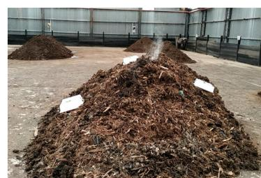
Figura 4: Compostaje de biosólidos en hileras con volteo mecánico
