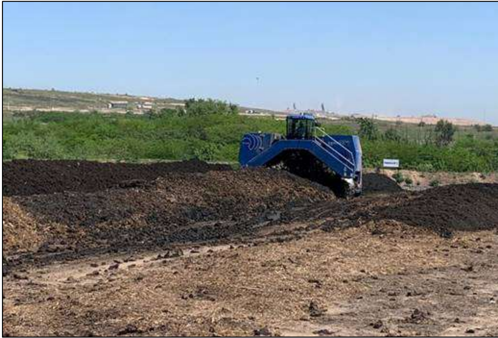
Figura 1. Compostaje de barros cloacales mezclados con clip de poda.
